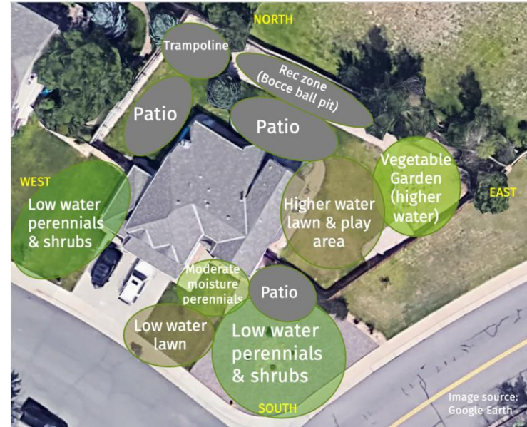
Ejemplo de un plan de hidro zona residencial simplificado
